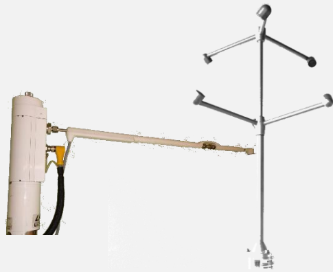
Kaasuanalysointori ja ultraäänianemometri ovat vuomittauksen keskeiset komponentit.
